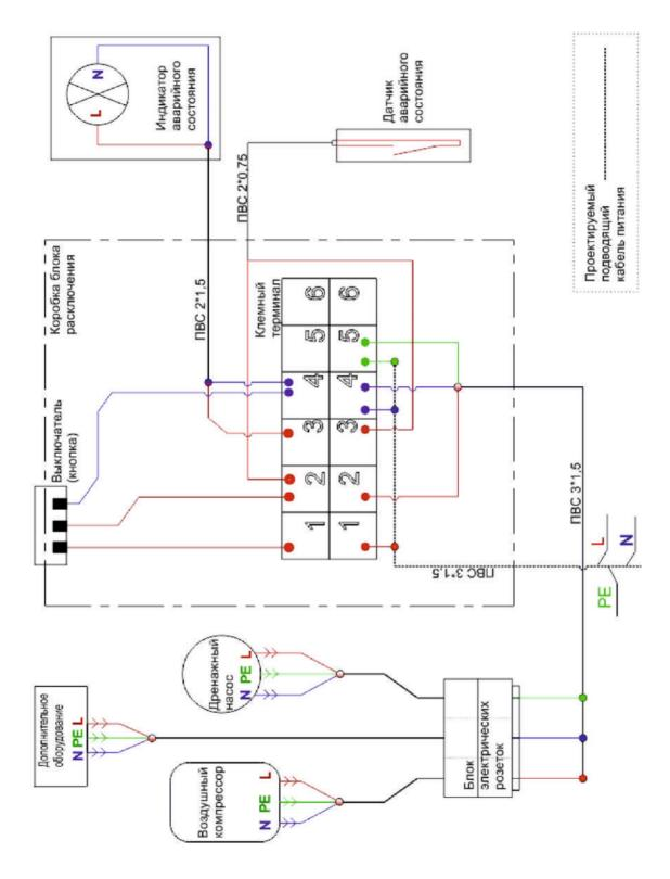
Блок расключения электрики станции очистки сточных вод поставляется в собраном виде. Необходимо провести расключение подводящего кабеля (кабеля питания). Рекомендуется применять трехжильный кабель с сечением 1,5мм.
