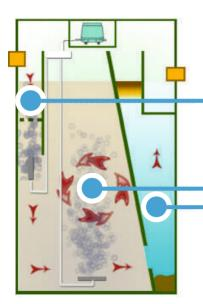
Сточные воды поступают в приемную камеру. Благодаря крупнопузырчатой аэрации и виброэкрану крупные фракции загрязнений разбиваются и перемешиваются до равномерной массы. Сточные воды первично аэрируются.
