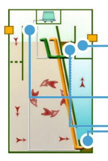
Камера сброса по умолчанию самотёчная. В неё может быть засыпан фильтрующий материал, который может дополнительно повысить качество очистки сточных вод до 2 раз. Так же в камере может быть установлен насос принудительного выброса очищенной воды, комплект для подключения насоса поставляется в комплекте со станцией.
